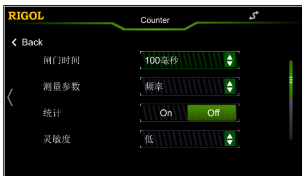
图 2-15 频率计参数设置界面
