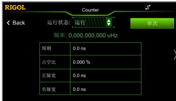
图 2-17 频率计参数测量界面
