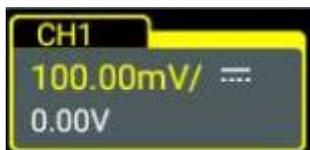
通道状态标签中显示的信息与当前通道设置有关（与通道的开/关状态无关）。打开通道后，根据输入信号调整通道的垂直档位、水平时基、触发方式以及触发电平等参数，使显示的波形易于观察和测量。
