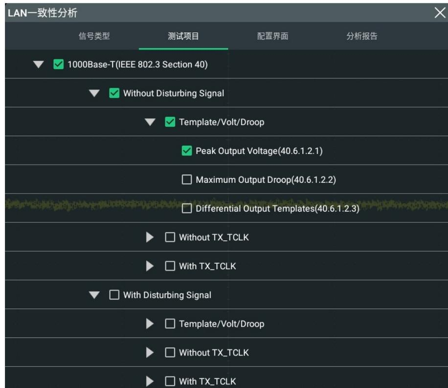
图 18.5 1000Base-T 信号测试项目
