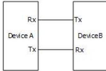
图 17.4 RS232 串行总线示意图
