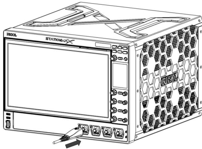
图 4.6 连接有源探头
