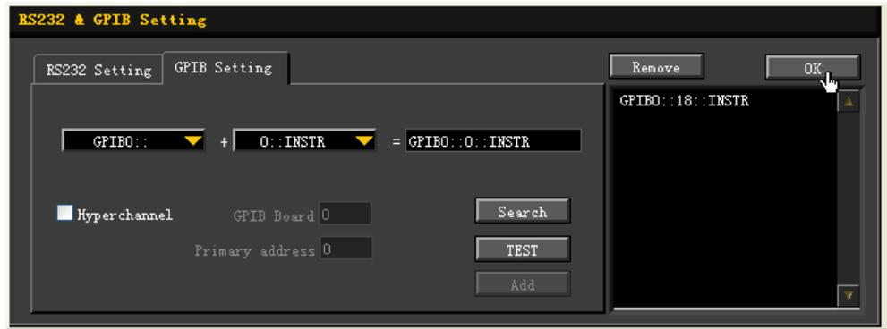
图 24.2 确认 GPIB 连接设备
