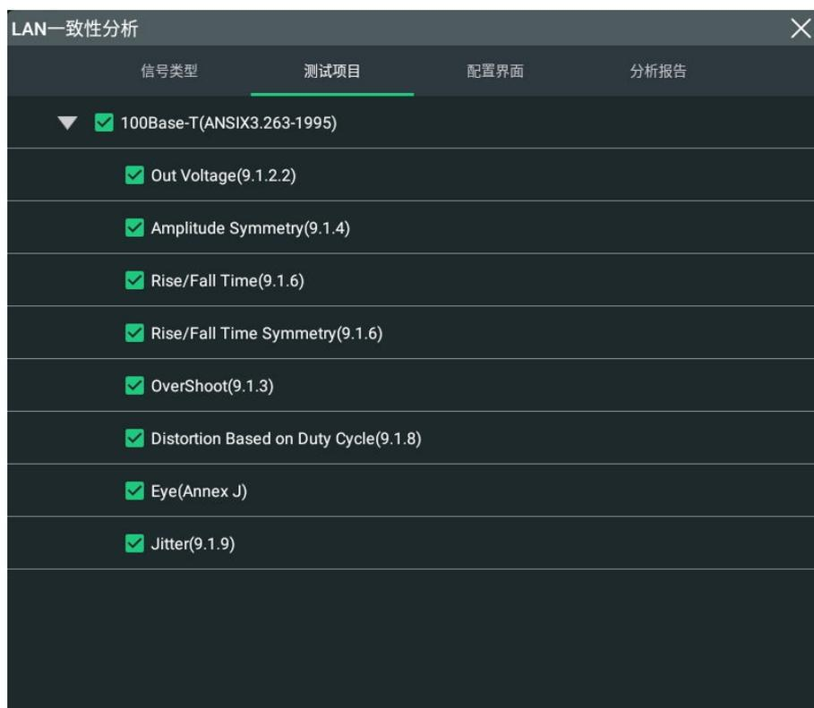
图 18.4 100Base-T 信号测试项目
