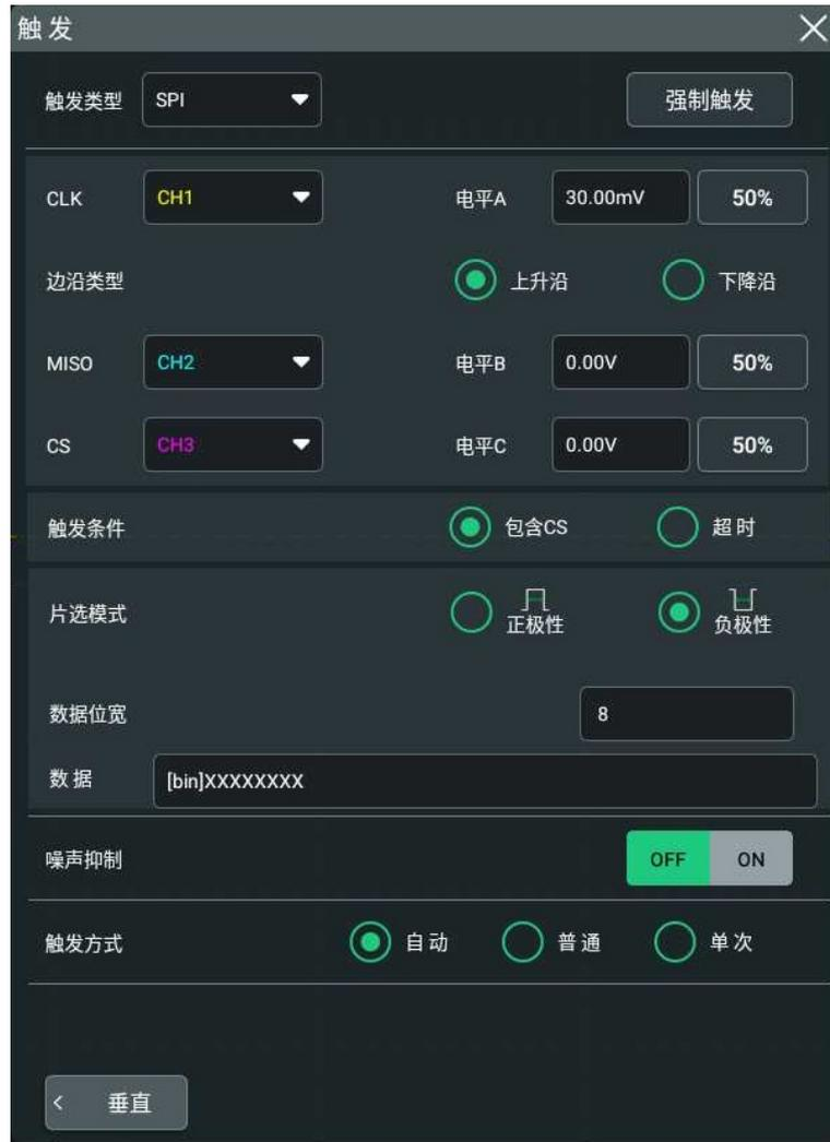
图 8.31 SPI 触发配置菜单
