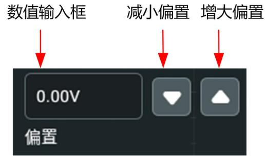
偏置电压的取值范围与输入阻抗和垂直档位的配置有关。
