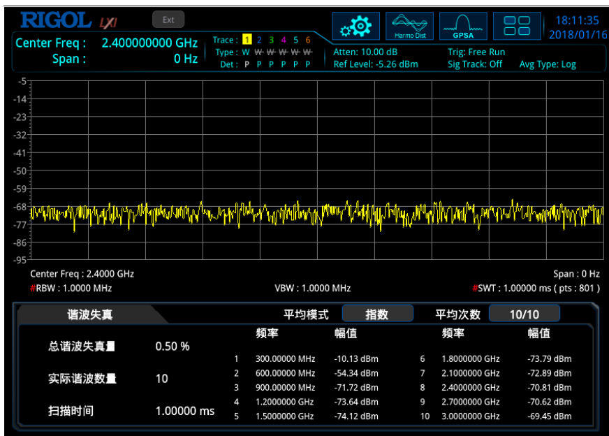
图 2-11 谐波失真测量界面
