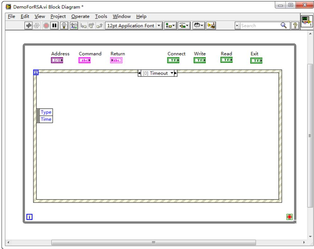
4. 添加事件（包括连接仪器、写操作、读操作和退出）。
