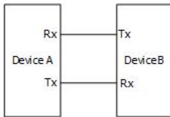
图 18.4 RS232 串行总线示意图
