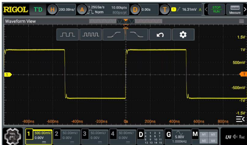
그림 10-6. 오실로스코프 사각파 표현 확인
