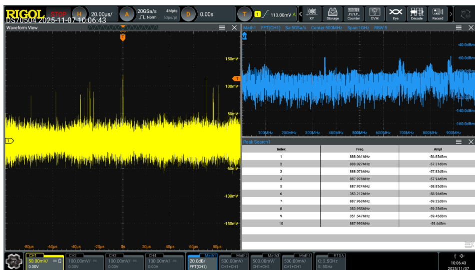
그림 11-2. 노이즈가 포함된 파형을 분석하기 위한 FFT 활용 예시
