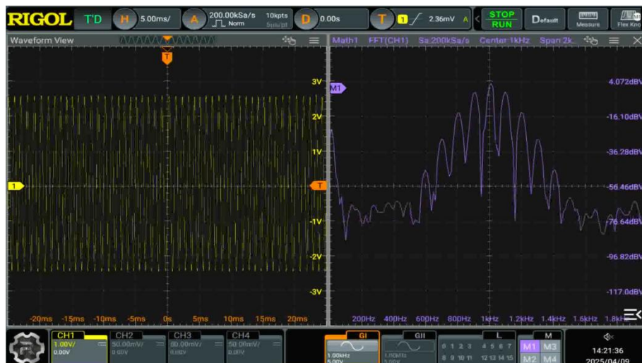
그림 12-1. 변조된 통신 신호의 예시 - FM(Frequency Modulation) 신호
