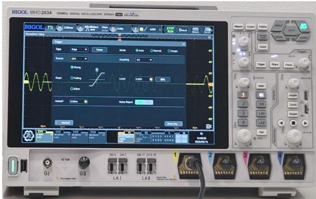
그림 14-4. Burst 신호를 Holdoff 기본값으로 측정했을 때의 화면
