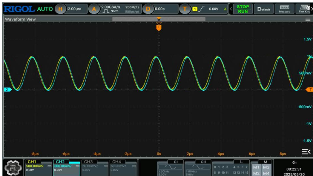
그림 16-1. 위상차가 존재하는 두개의 파형 예시
