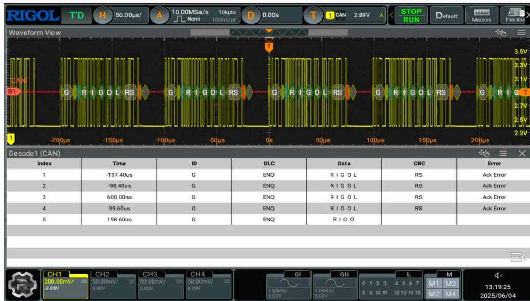
그림 18-2. CAN 신호의 예시
