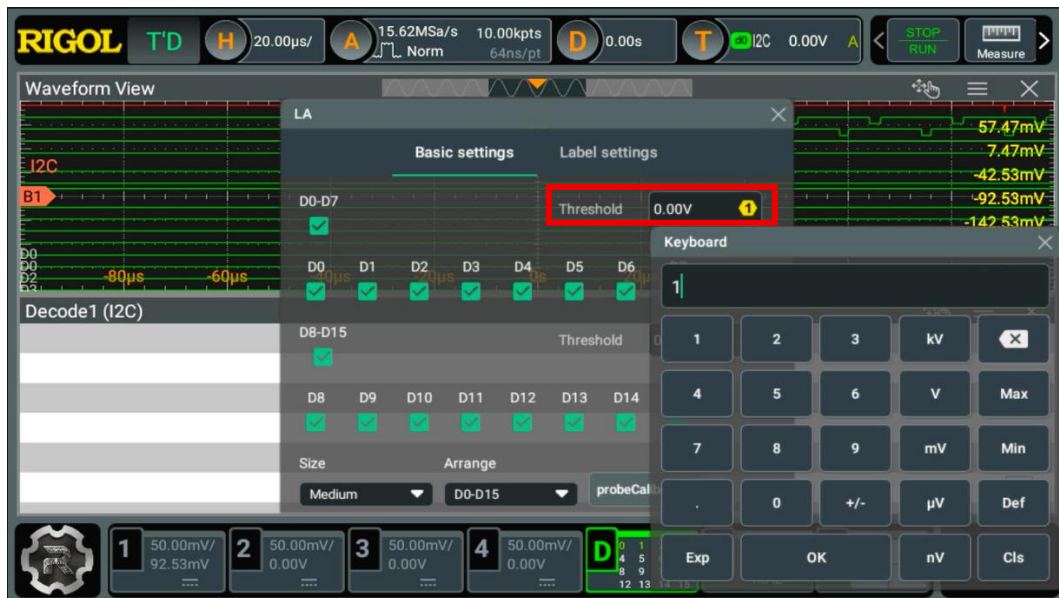
그림 19-2. LA 창에서 Threshold 설정하는 방법
