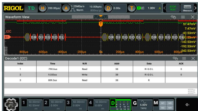
그림 19-4. 디지털 버스로 I2C 디코딩했을 때의 예시
