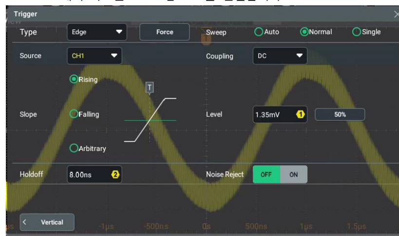
그림 26-7. 수직 히스토그램 실습을 위한 트리거 설정
