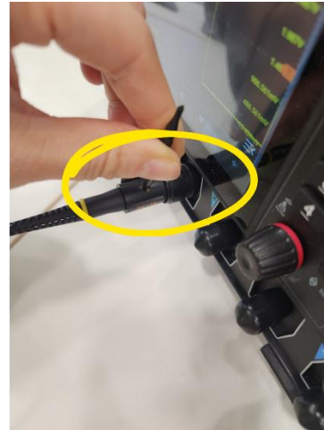
그림 5-9. 보정 나사를 이용한 보정 교정
