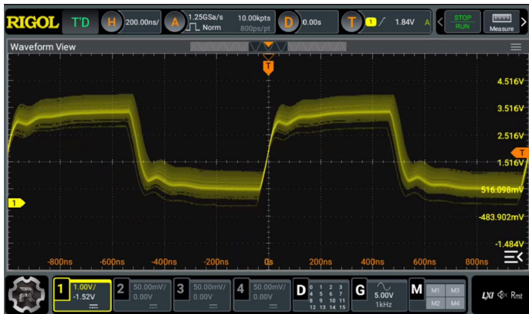
그림 6-9. 그라운드를 연결하지 않은 SQUARE 파형
