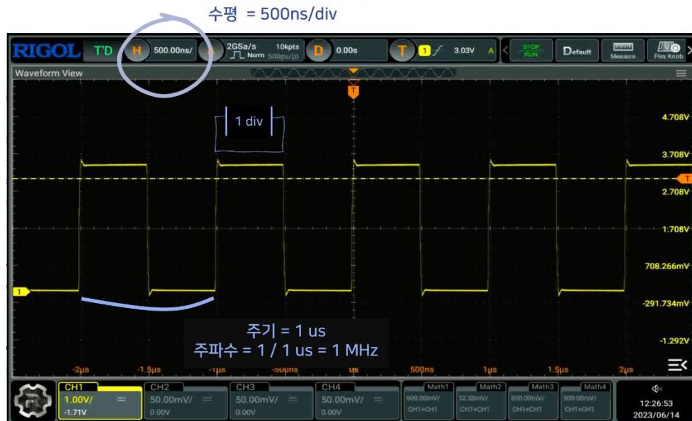
그림 7-2. 오실로스코프 주기, 주파수 측정 방법
