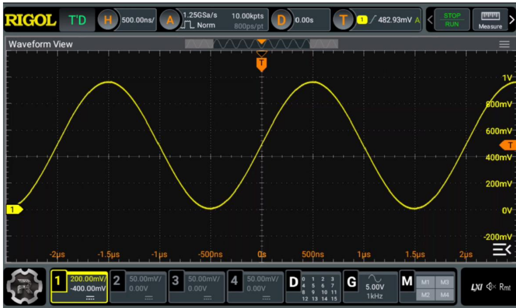
그림 7-4. 200mV/div, -400mV offset, 500ns/div로 설정한 화면
