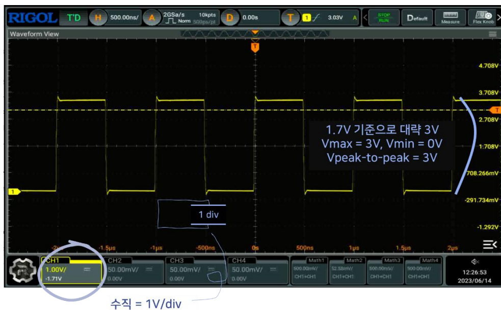
그림 7-1. 오실로스코프 전압 측정 방법
