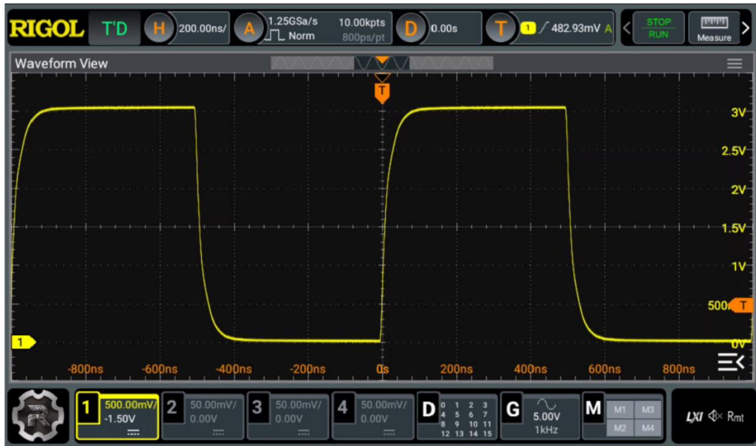
그림 7-6. -1.5V offset, 500mV/div, 200ns/div으로 설정한 화면
