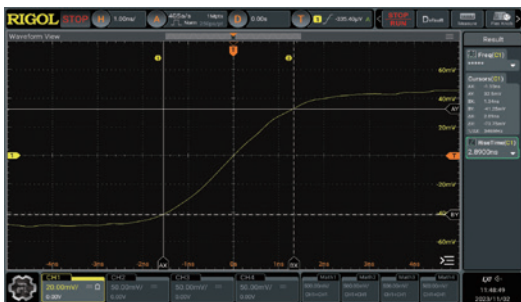
60 MHz的方波与50 MHz的可调边沿脉冲输出, 波形上升时间低至3 ns, 满足不同应用的波形需求
