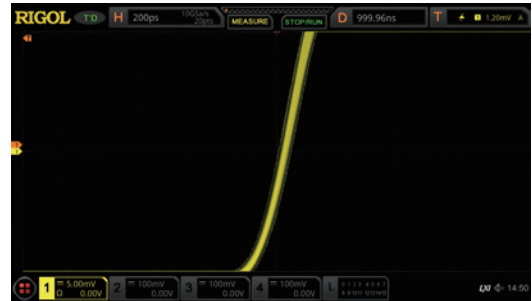
基于RIGOL独创的SiFi II技术, DG800Pro/900Pro系列可逐点生成任意波, 不失真地还原信号。采样率精确可调, 相比传统DDS信号源, 产生的信号抖动更低, 所有输出信号抖动低至200ps(rms)
