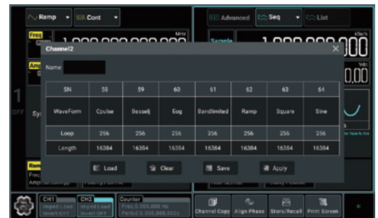
最高支持64个波形事件数量以及256个重复数量, 可一次性加载一个序列中想需要顺序执行的多个测试用例, 实现测试用例的无缝切换, 大大提高测试效率
