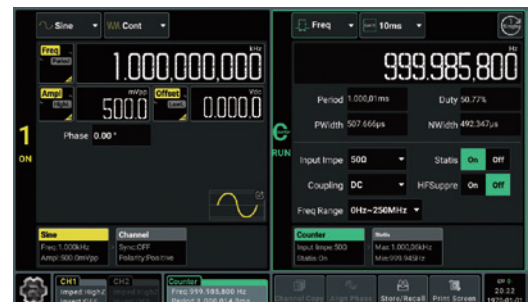
超便携函数/任意波形发生器系列支持最高测量频率达1 GHz, 可以测量常见的VHF、UHF等高频信号的频率, 进行相关调试。
