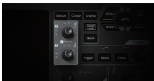
双多功能旋钮设计, 告别单旋钮的复杂切换步骤, 实现更高效的交互。
